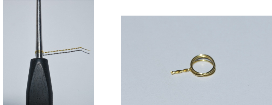
Construcción del anillo de alambre en la parte baja del tudelero y vista del resultado obtenido 26 .
