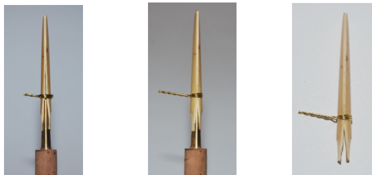
Vista lateral de una caña antes y después de ser cerrada con alambre y de la misma caña extraída del tudel 28 .
