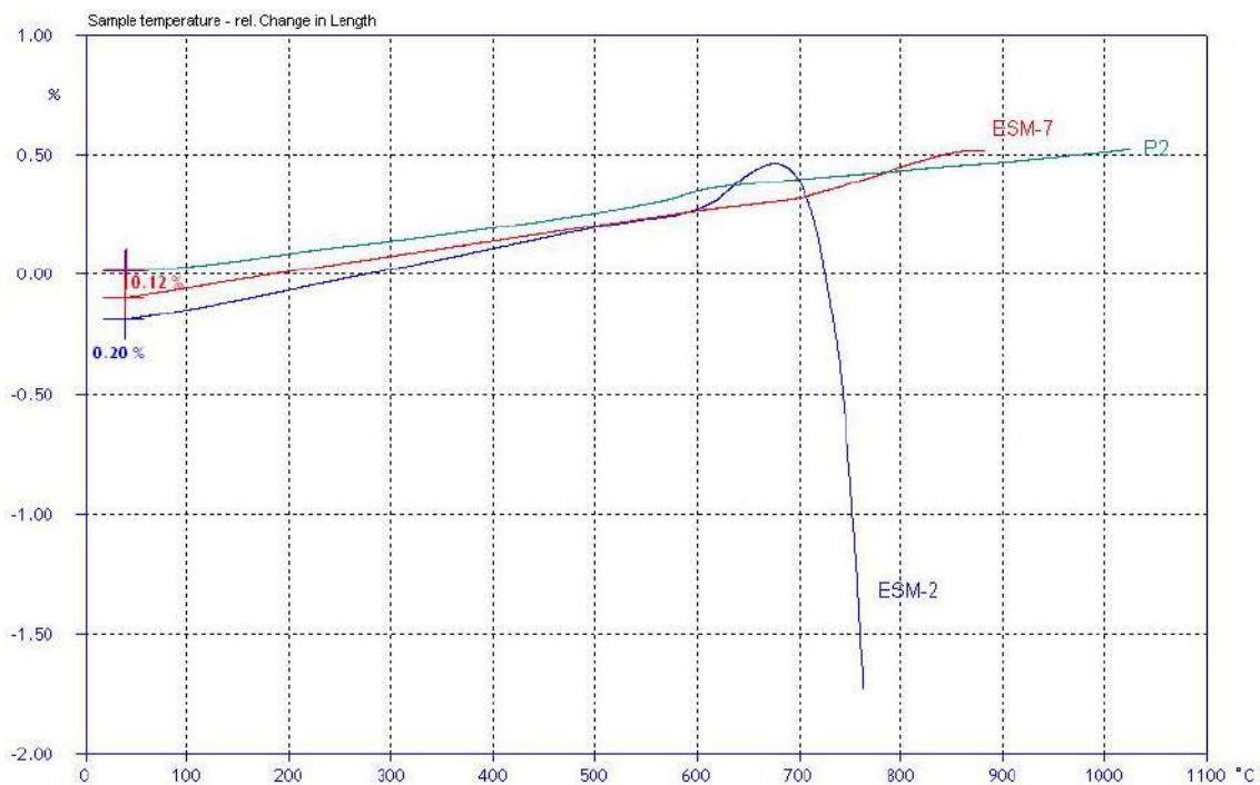
Figura 7: Ajust dilatomètric entre la pasta P2 i els esmalts ESM2 i ESM7.
