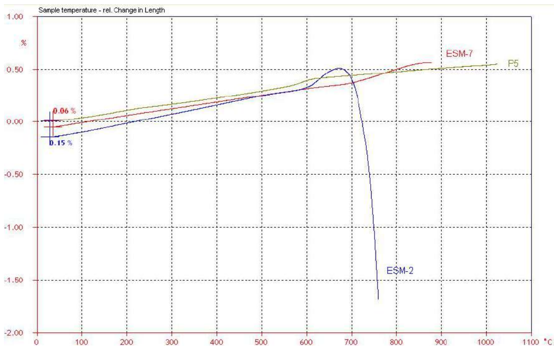
Figura 8: Ajust dilatomètric entre la pasta P5 i els esmalts ESM2 i ESM7.
