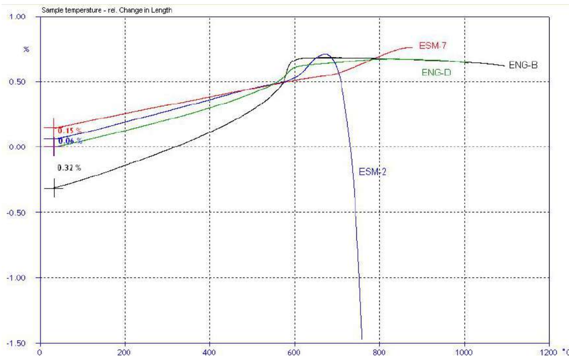
Figura 10: Ajust dilatomètric entre l'engalba ENG-D i els esmalts ESM2 i ESM7 . Dilatometria de l' ENG-B .
