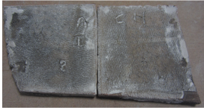
Figura 16: Peça de superfície rugosa cuita a baixa temperatura.
