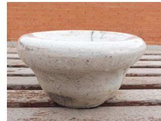
Figura 4: Peça cuita a temperatura superior a la d'estirada.
