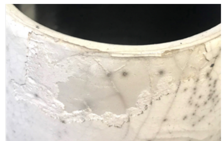
Figura 3: Detall de les capes superposades en una peça cuïta.
