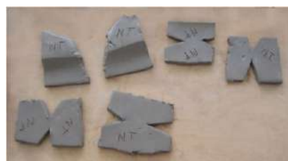
Il·lustració 9 Peces amb cants vius i diferències d'espessor.
