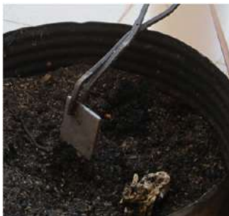
Il·lustració 1 Peça introduïda en calent en matèria orgànica.
