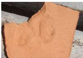
Il·lustració 5 Bombolles en peça rebentada.
