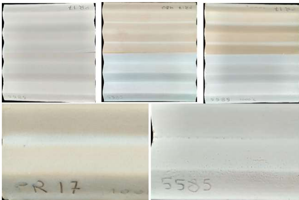
Figura XX: Aspecte superficial dels esmalts. PECES SUPERIORS d' esquerra a dreta: 1- Esmalt 5585 i PR17 cru. 2-Esmalt 5585 i PR17 cuit a 980°C. 3-Esmalt 5585 i PR17 cuit a 1000°C. PECES INFERIORS d' esquerra a dreta: 4-Detall de l'esmalt PR17 cuit a 1000°C. 5-Detall de l'esmalt 5585 cuit a 1000°C.
