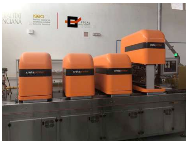
Figura 1: Esquerra: Fotografia d'una màquina Inkjet per a decoració ceràmica. Dreta: Capçal Xaar per a decoració (accessible des de https://www.xaar.com/media/1442/xaar-tf-technology-datasheet.pdf )
