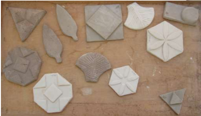
Il·lustració 10 Peces emmotllades, a l'esquerra, i peces de planxes acoblades dalt i a la dreta.
