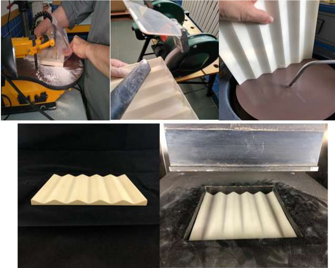
Figura XVII: Imatges del procés de tall, pilot, acabat i acoblament dins del plat de la premsa.
