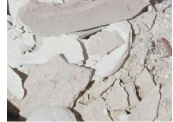
Il·lustració 4 Restes d'explosions de peces durant l'escalfament.
