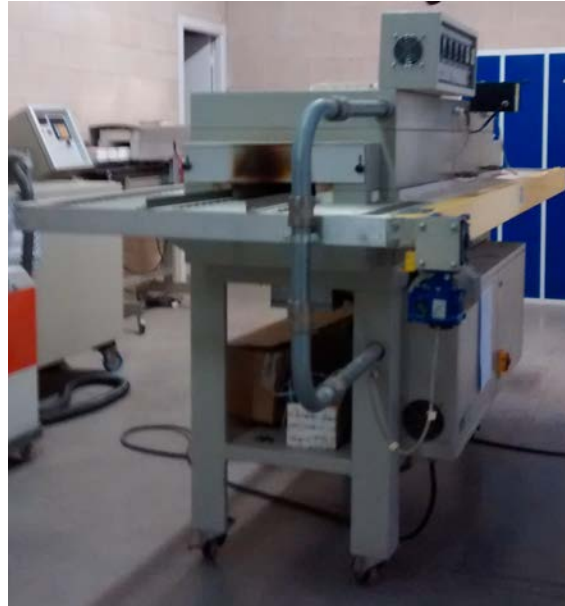
Figura 8. Forn monostrat de proves amb obertura per a làser.
