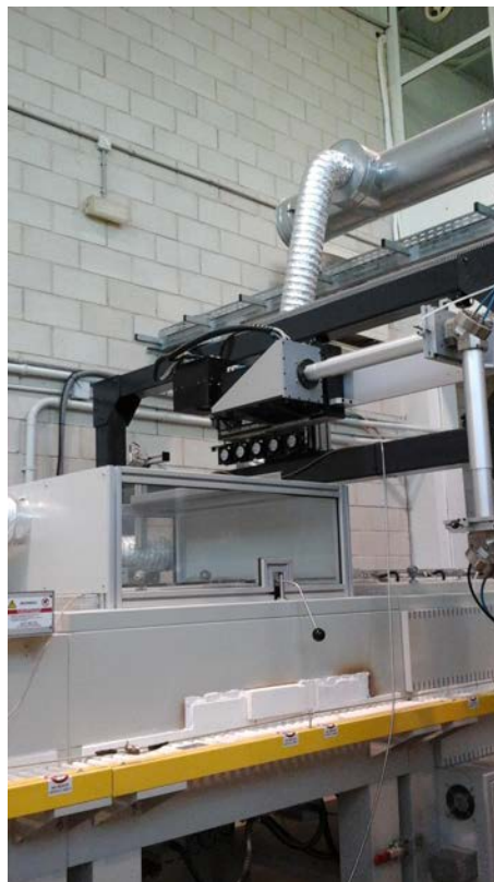
Figura 2. Forn monostrat de dimensions industrials amb làser incorporat a la zona de cocció.
