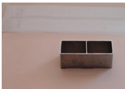
Figura 5. Peça esmaltada amb patí de 0,7mm d'espessor.
